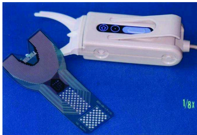
Slika 2b. Ultra tanke senzor folije i ručni konvertor podataka Fig 2b. Ultra thin sensors and T-Scan scanning handle
