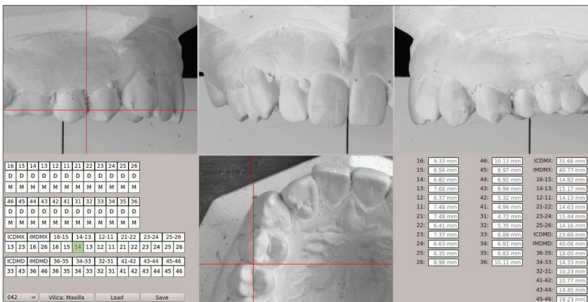
Figure 2. OrthoPhoto4D measurement module user interface Slika 2. Izgled modula za merenja u OP4D
