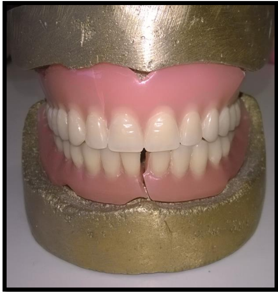
Slika 5.16- Izgled TZP nakon testa pritiska na Zwick Roel Z 010 aparatu
