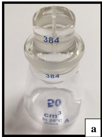
Slika 4.2- a) Piknometar b) formula za izračunavanje specifične gustine čvrstog tela
