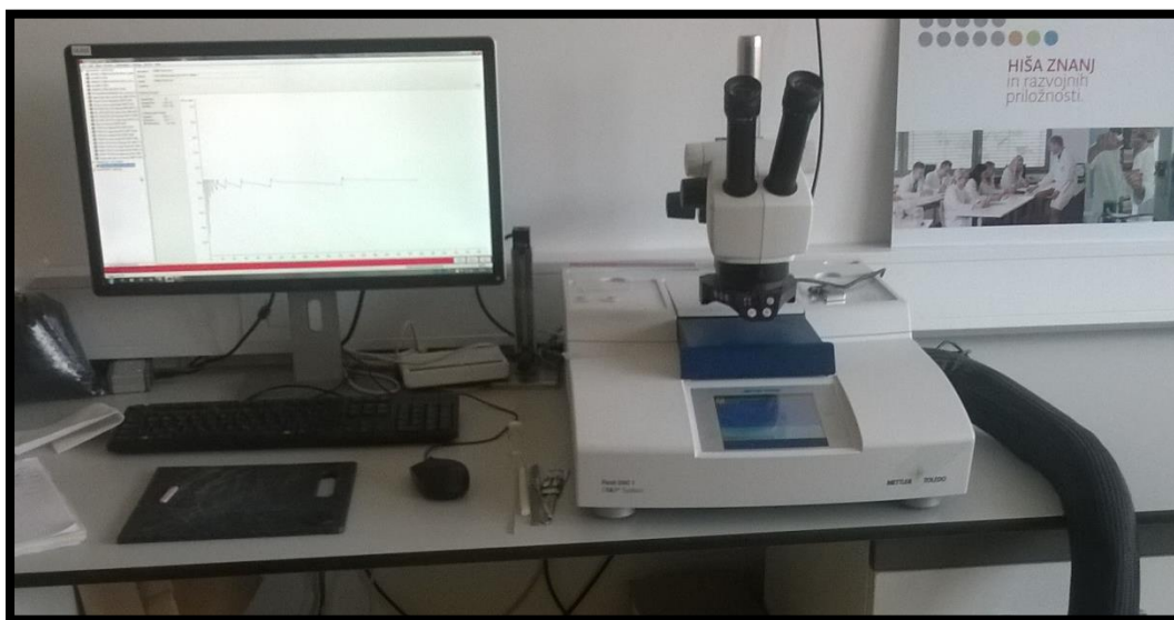
Slika 4.10 Flash DSC, Mettler Toledo (FTPO Slovenj Gradec)
