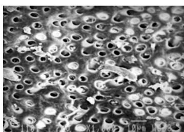
**Slika 3.** Površina zida kanala ispiranog lateralno perforiranom iglom (SEM x 1000). Na zidu kanala uočava se nekoliko manjih konglomerata debrisa (ocena 2), prisutna mala količina razmaznog sloja (ocena 2).
