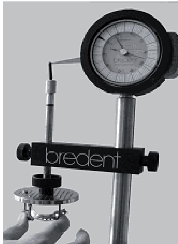
Slika 2. Razdvajanje spoljašnje od unutrašnje kruna Figure 2. The separation the outor from the inner crown.
