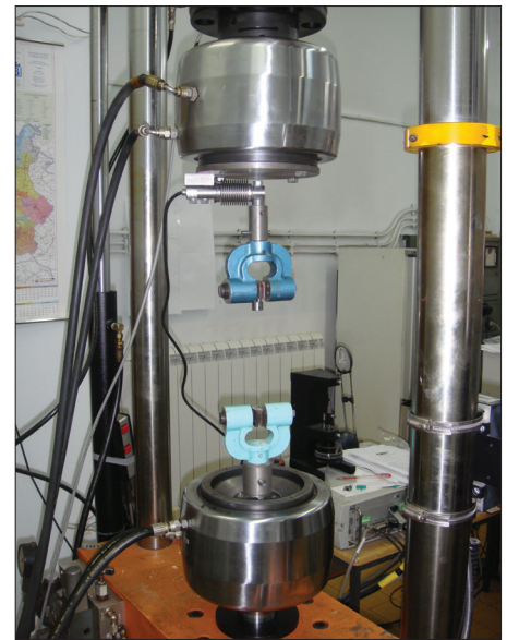
Figure 2. Universal testing machine with the clamps used to measure the separation force Slika 2. Izgled univerzalne servohidraulične kidalice sa hvataljkama na kojoj je merena sila razdvajanja
