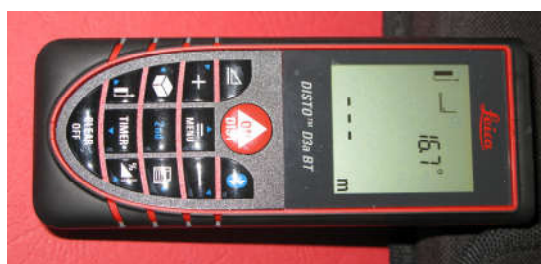
Slika 6.23. Leica Disto D3 BT merenje ugla
