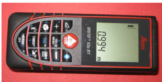
Slika 6.22. Leica Disto D3 BT merenje rastojanja
